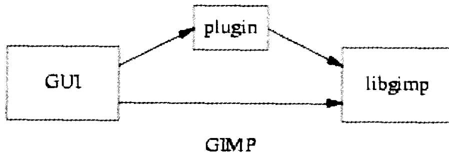
图 4.2 载入插件的 GIMP 中调用和被调用关系图
